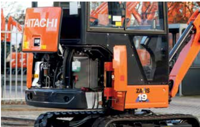
Le capot moteur s'ouvre verticalement, ce qui est idéal pour les espaces réduits.
