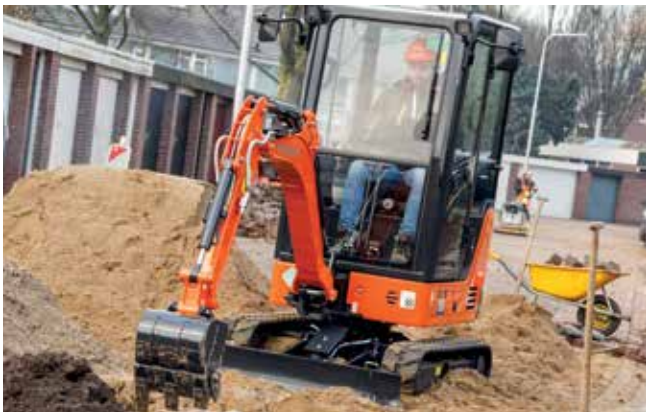
Le flexible hydraulique sur l'accessoire avant de la machine se trouve à l'intérieur de la flèche pour une protection supplémentaire.
