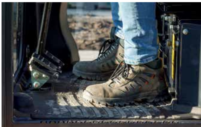
Des pédales de translation repliables peuvent être utilisées à la place d'un levier manuel.
