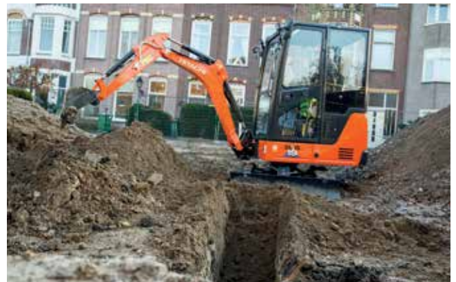
Le vérin de flèche placé sur le dessus de la flèche minimise les durées d'immobilisation, en raison du contact réduit avec le vérin.
