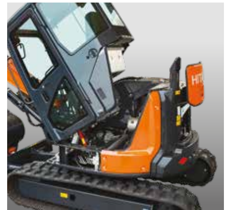
Le plancher inclinable garantit un accès facile au moteur et à la soupape de commande pour un entretien rapide.
