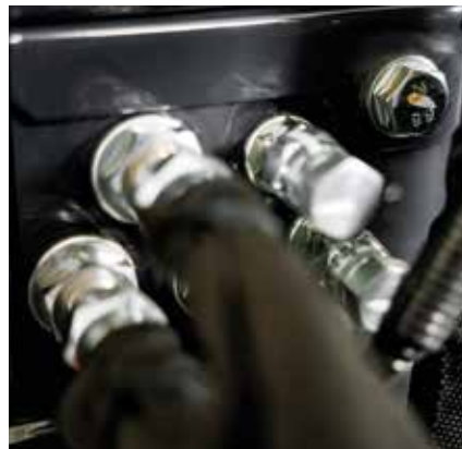
Le raccord rapide (en option) sous la boîte à outils permet une installation ultérieure sécurisée.
