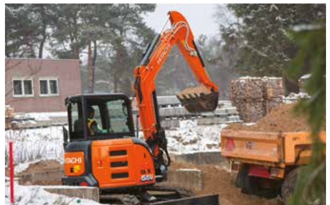
Grâce à son rayon de rotation arrière court, la ZX55U-6 convient parfaitement aux travaux dans les espaces réduits.
