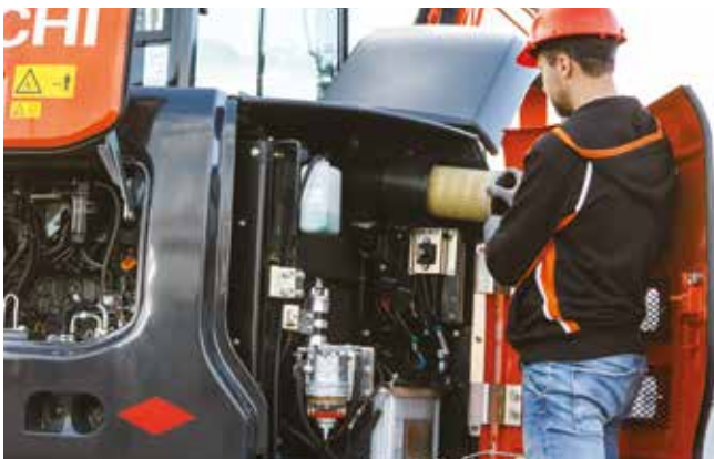
Die Wartungspunkte für die Tagesinspektionen wurden in leicht zugänglichen Gruppen angeordnet.
