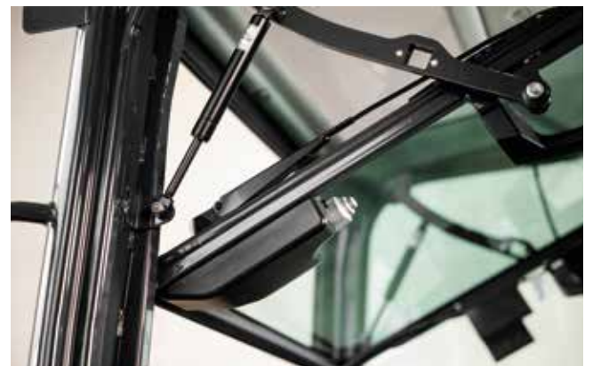
Die elektrisch betätigte Frontscheibe lässt sich ganz einfach leichtgängig öffnen.
