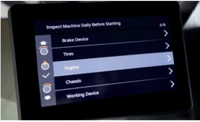
Des rappels d'inspections quotidiennes facilitent la vie des opérateurs.
