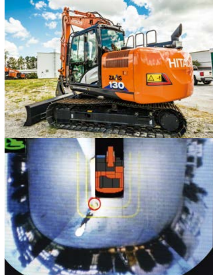
機体に搭載した物体検知センサーとカメラで、機械を中心とした俯瞰映像を運転席内のモニターで確認できる「エアリアルアングル」。運転の安全性を高め、接触事故低減に寄与する機能だ。
