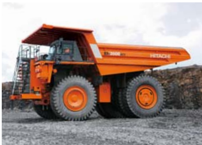
南アフリカで稼働するEH3500AC II リジッドダンプトラック
