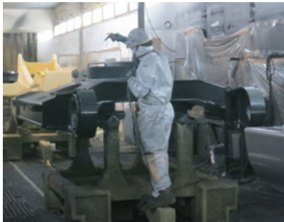
ハインリッド塗料の吹き付け
