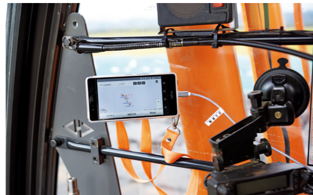
Solution Linkage Mobileの地図画面。GPS受信機に紐付けされた機械や作業員の位置情報や一覧がアイコンで表示される。
