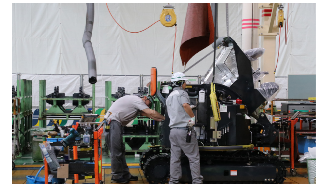
階段の昇降や高所での作業を極力なくし、腰をかがめず作業できる高さに。工具ワゴンもコンベアラインで作業者と一緒に移動し、持ち運びの負担も軽減。
