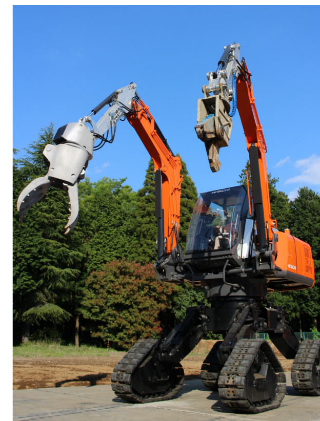
四脚クローラ方式双腕型コンセプトマシン
