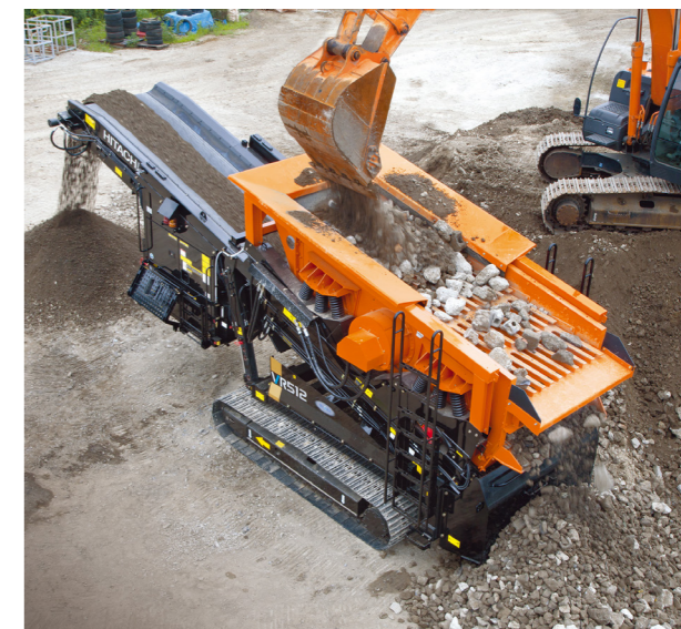
被災現場で発生した土砂などの分別処理に、自走式スクリーンが活用できる。
