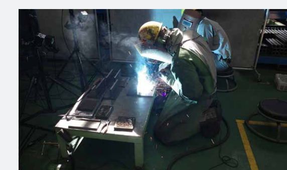
若手技能者の溶接作業を計測している様子
