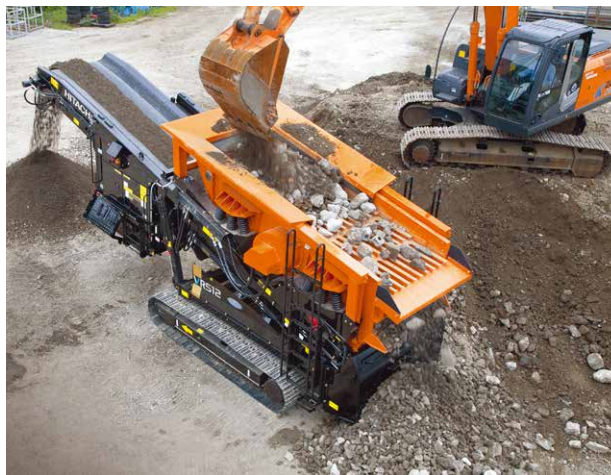
被災現場で発生した土砂などの分別処理に、自走式スクリーンが活用できる
