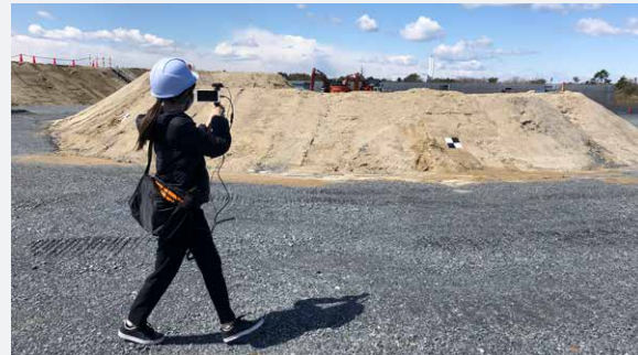
専門的な知識や経験が無くても土量の計測が可能になる
