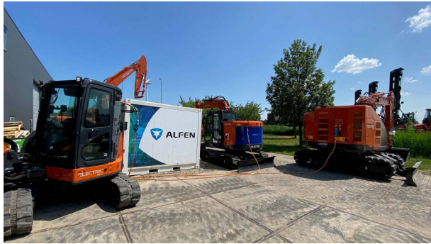
アルフェン社の可搬式充電設備から給電する日立建機のバッテリー駆動式ショベル
