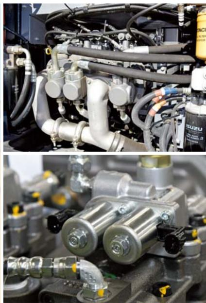
た。電気磁石で弁を動かす電磁弁は応答が素早く、的確なため、より繊細な制御が可能になったのだ。個々のオペレータが求める微妙な操作感覚に応えるため、時代とともに搭載する電磁弁の数も増え、最近のモデルでは20～30個の電磁弁を採用。いくつもの電磁弁がまとまり、ユニット化
