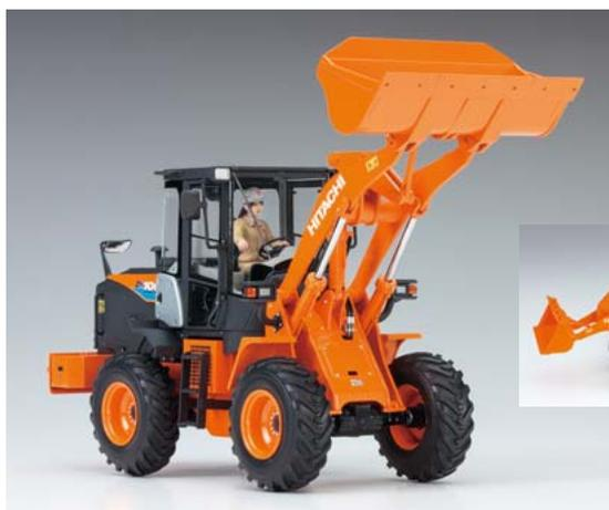
プラモデルメーカー「ハセガワ」による、1/35スケール未塗装プラスチックの組み立てキット。リフトアームが上下に動くほか、車体は中央のヒンジで左右に可動します。
