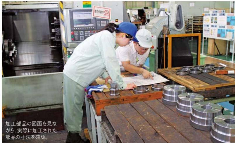
加工部品の図面を見ながら、実際に加工された部品の寸法を確認。
