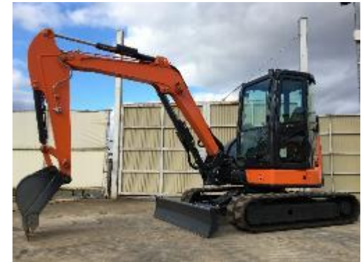
バッテリー駆動式5t級小旋回試作機
