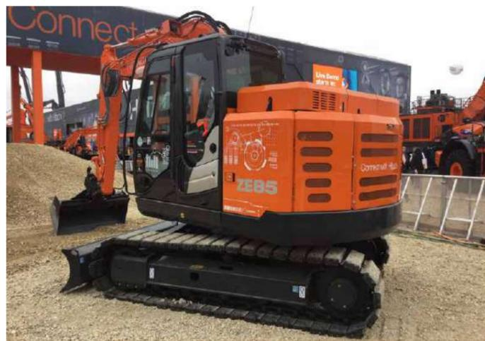
電動ショベル「ZE85」(写真はコンセプトモデル)
